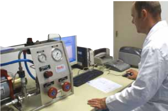
De geperste slang wordt onderworpen aan een druktest
