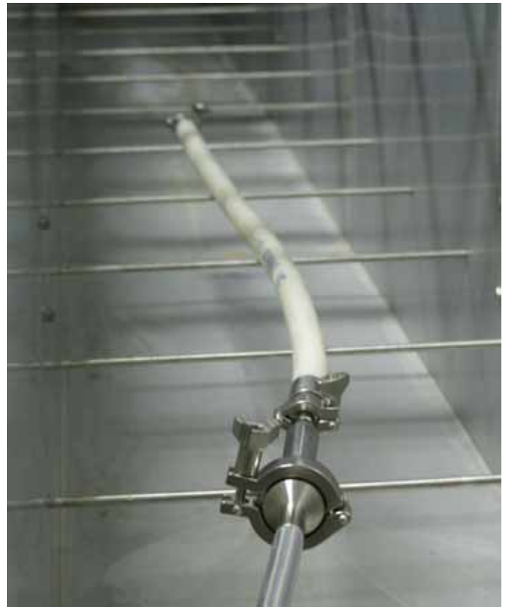
Testbank waar de koppeling wordt getest
